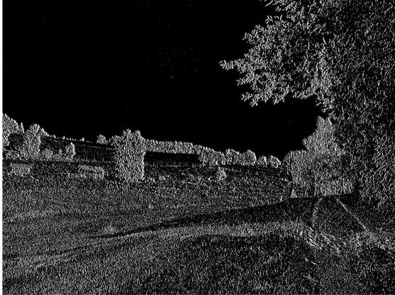
**Bild 11** zeigt das Ergebnis des Sobelfilters. Die Werte wurden mit 10 multipliziert, um im Bild besser sichtbar zu sein.
